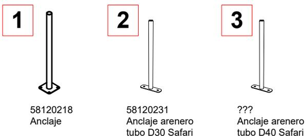
Cimentación válida para material sin cohesión (por ejemplo, arena) (EN-1176-1)
