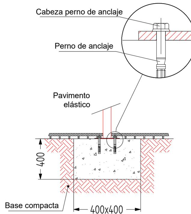
Cimentación válida con pavimento elástico (EN1176-1)
