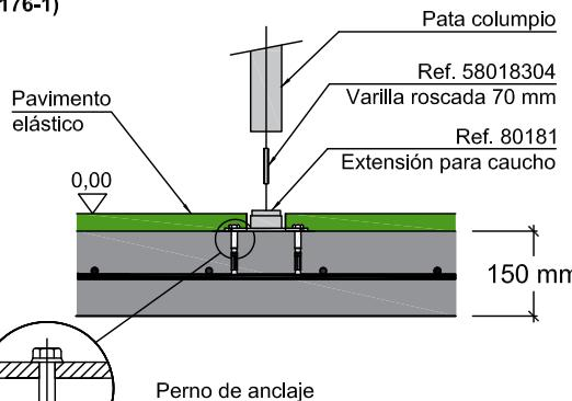
Solera de hormigón HM-20 de 15 cm de espesor en toda la zona de seguridad. Colocación de mallazo 20x20 cm ø6 mm y terminación fratasado mecánico.
