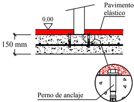
Solera de hormigón HM-20 de 15 cm de espesor en toda el área de seguridad. Colocación de mallazo 20x20 cm  $\varnothing$ 6 mm y terminación fratasado mecánico.
