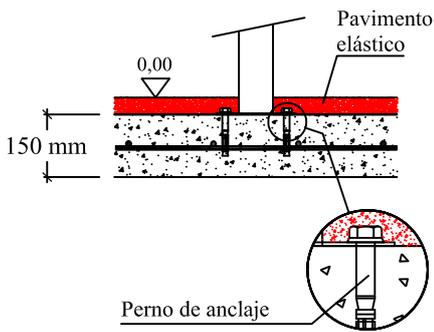
Solera de hormigón HM-20 de 15 cm de espesor en toda el área de seguridad. Colocación de mallazo 20x20 cm  $\phi$ 6 mm y terminación fratasado mecánico.
