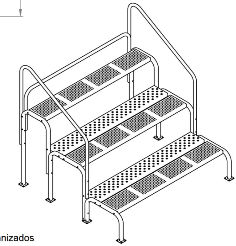
Estructura de chapa y tubo galvanizados
