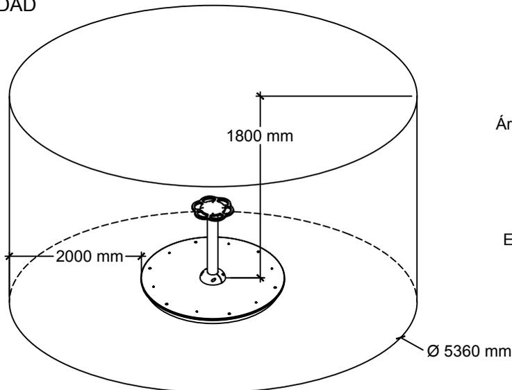
Área de seguridad según (EN1176-5:2019), con HIC 1000 para una altura máxima de caída libre de 1 m. Superficie: 22,56 m<sup>2</sup>.
