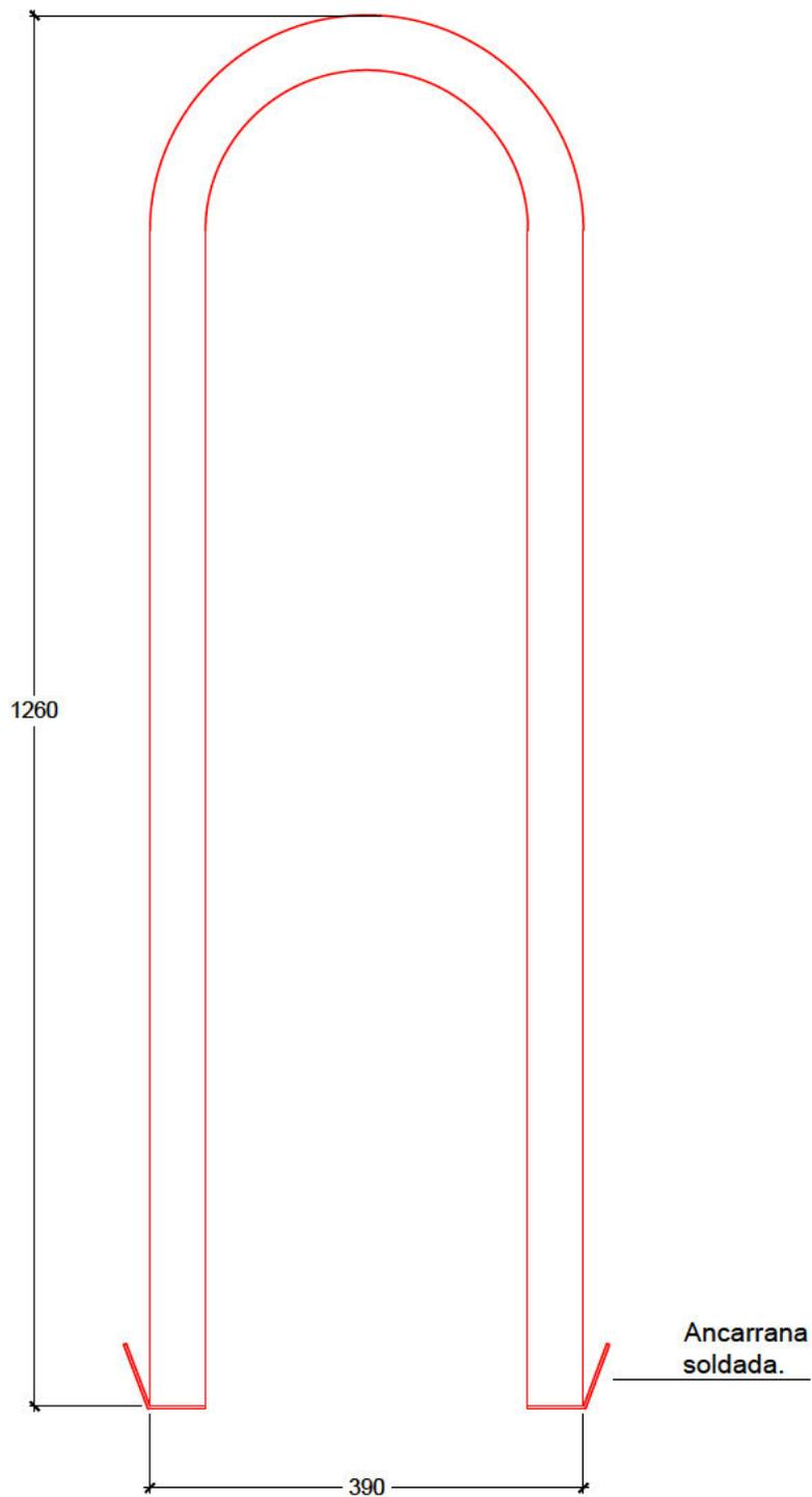
Tubo decapado de  $\text{Ø}50 \times 2 \text{ mm}$
