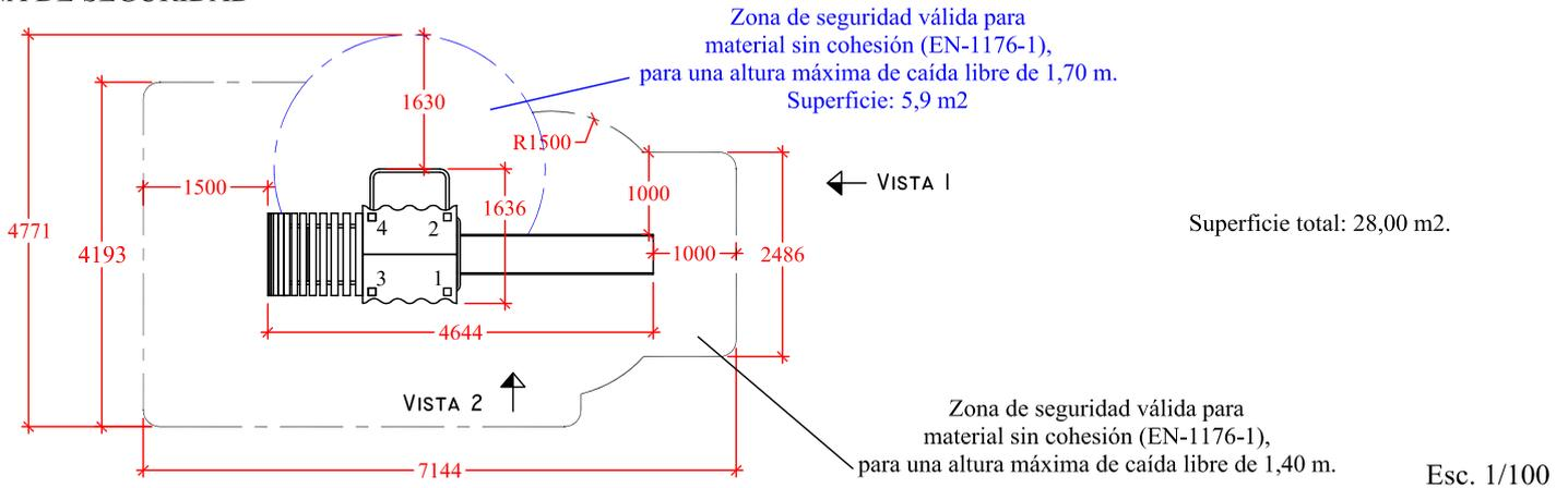
CIMENTACIÓN válida para material sin cohesión (por ejemplo arena) (EN-1176-1).
