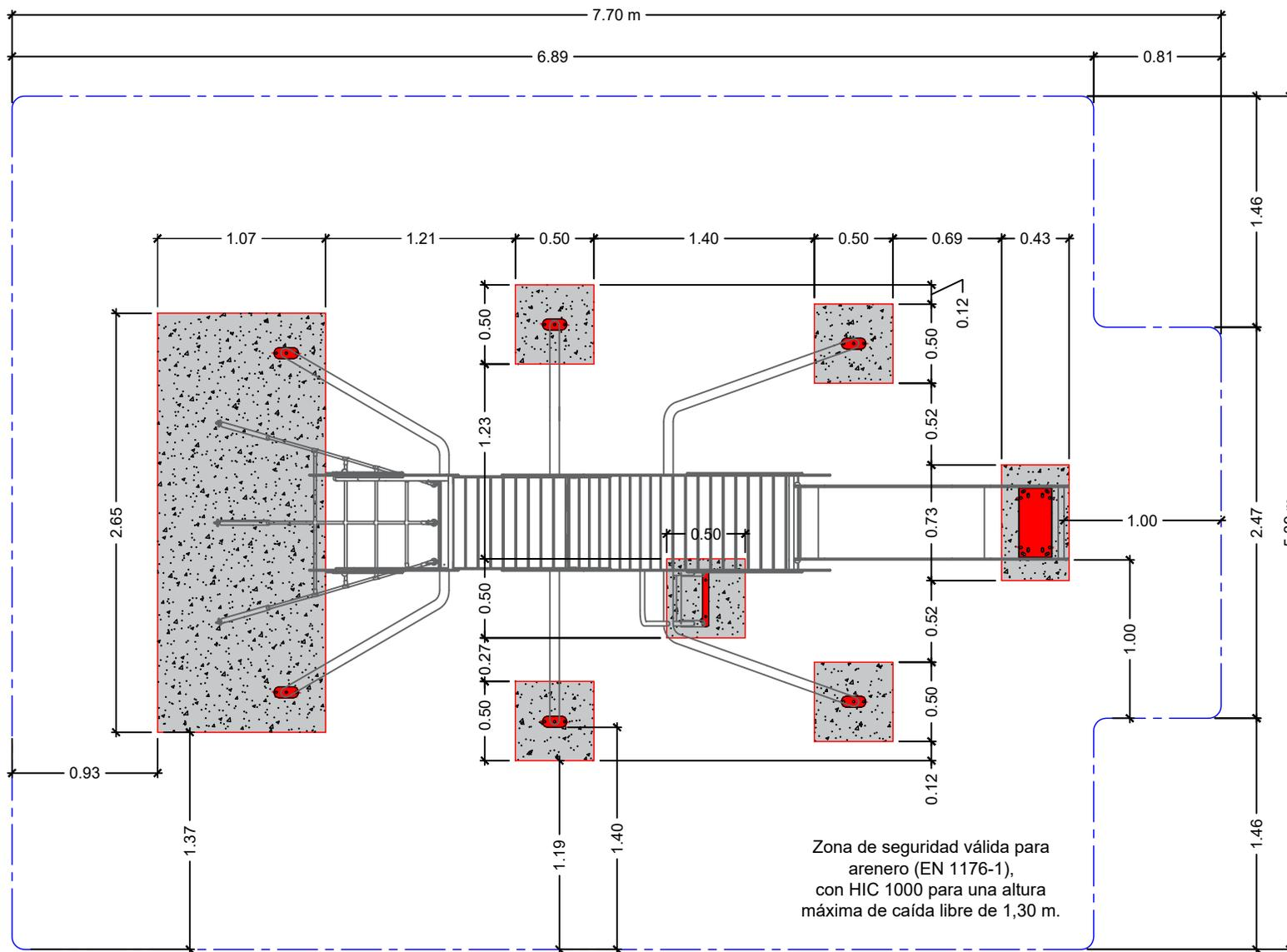
Zona de seguridad válida para arenero (EN 1176-1), con HIC 1000 para una altura máxima de caída libre de 1,30 m.
