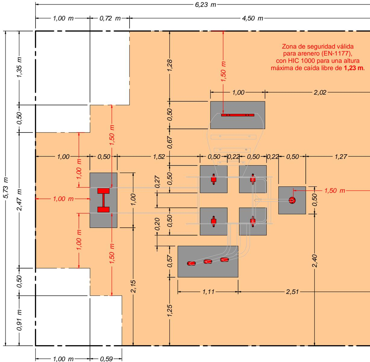
Zona de seguridad válida para arenero (EN-1177), con HIC 1000 para una altura máxima de caída libre de 1,23 m.
