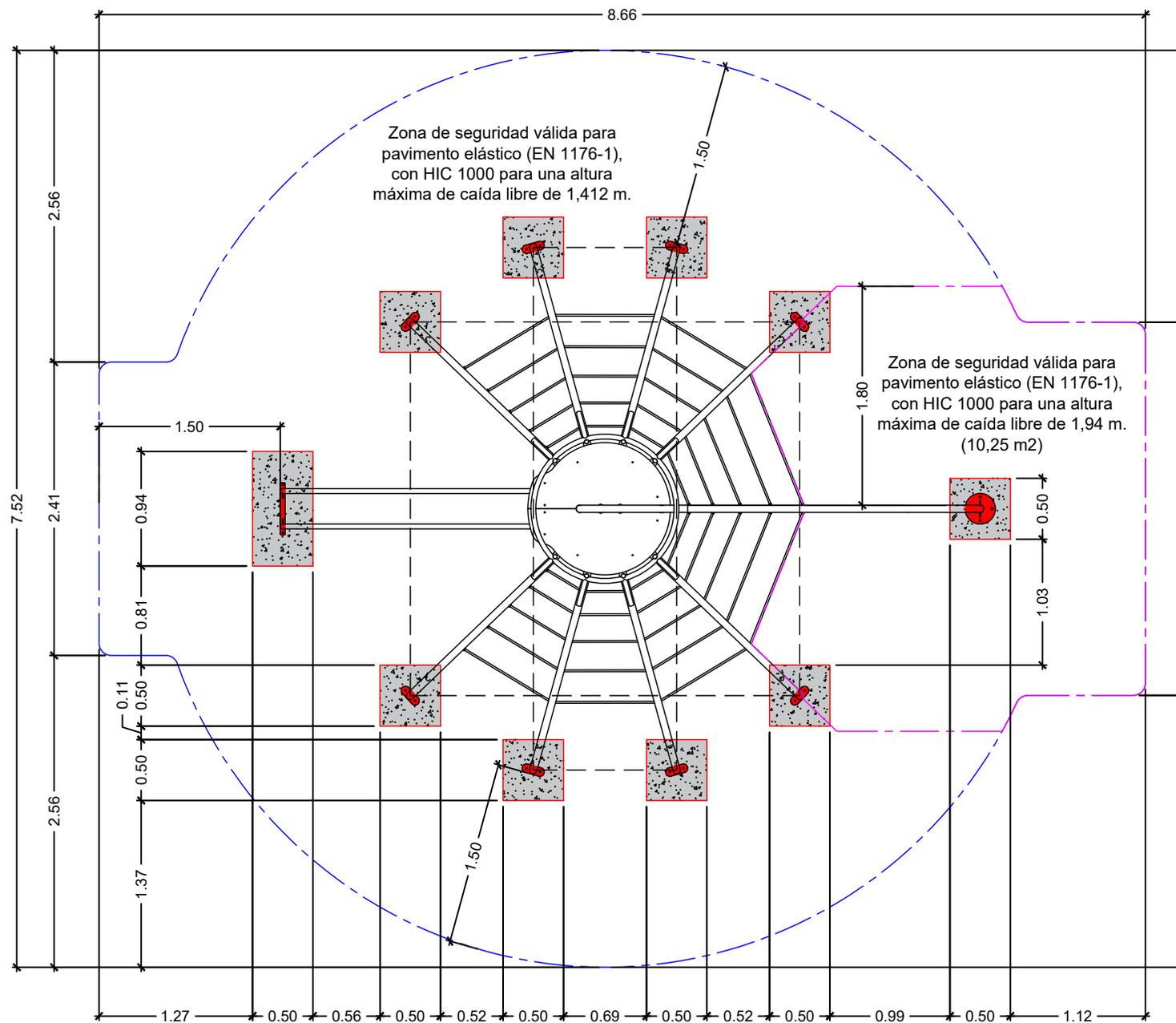
Zona de seguridad válida para pavimento elástico (EN 1176-1), con HIC 1000 para una altura máxima de caída libre de 1,412 m.
