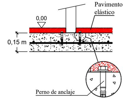
Solera de hormigón HM-20 de 15 cm de espesor en toda el área de seguridad. Colocación de mallazo 20x20 cm ø6 mm y terminación fratasado mecánico.
