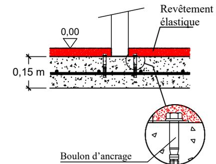
Dalle en béton HM-20 de 15 cm d'épaisseur sur toute la zone de sécurité. Pose d'un treillis soudé 20x20 cm ø6 mm et finition talochée mécaniquement.
