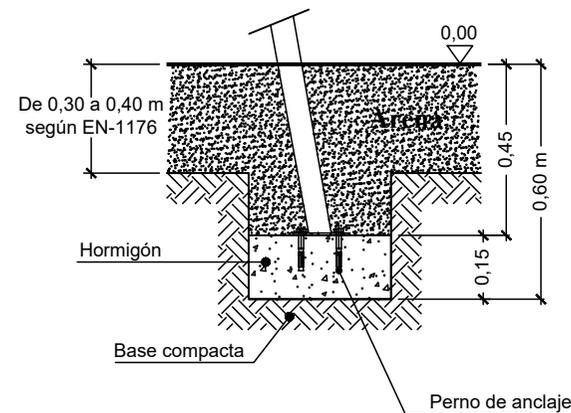
Zona de seguridad válida para material sin cohesión (EN1176-1).
