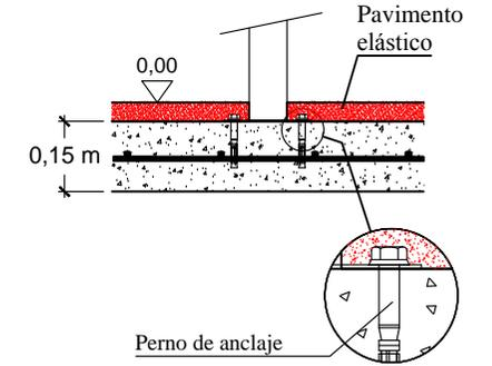
Solera de hormigón HM-20 de 15 cm de espesor en toda la zona de seguridad. Colocación de mallazo 20x20 cm  $\phi$ 6 mm y terminación fratasado mecánico.
