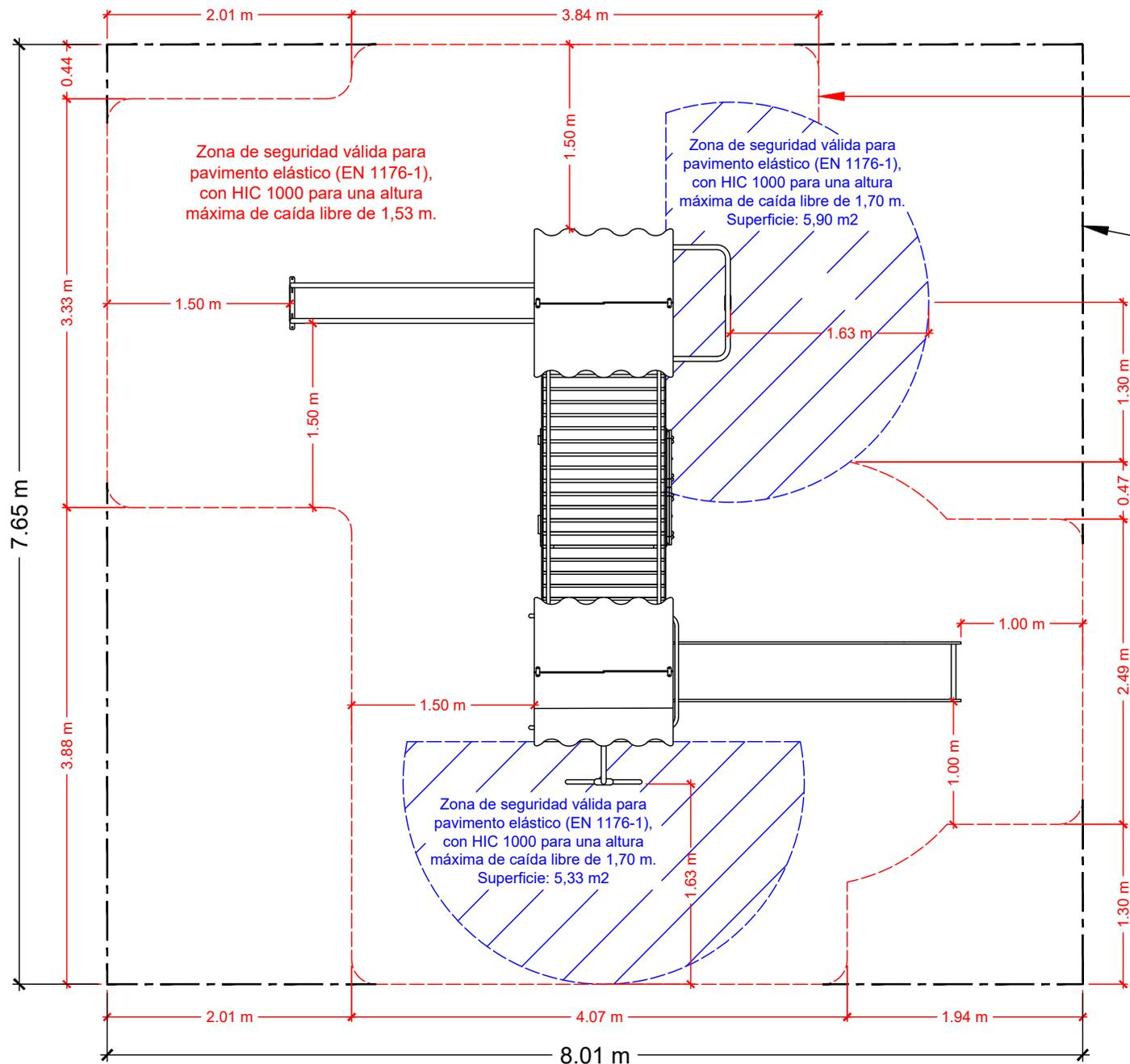
Zona de seguridad válida para pavimento elástico (EN 1176-1), con HIC 1000 para una altura máxima de caída libre de 1,53 m.
