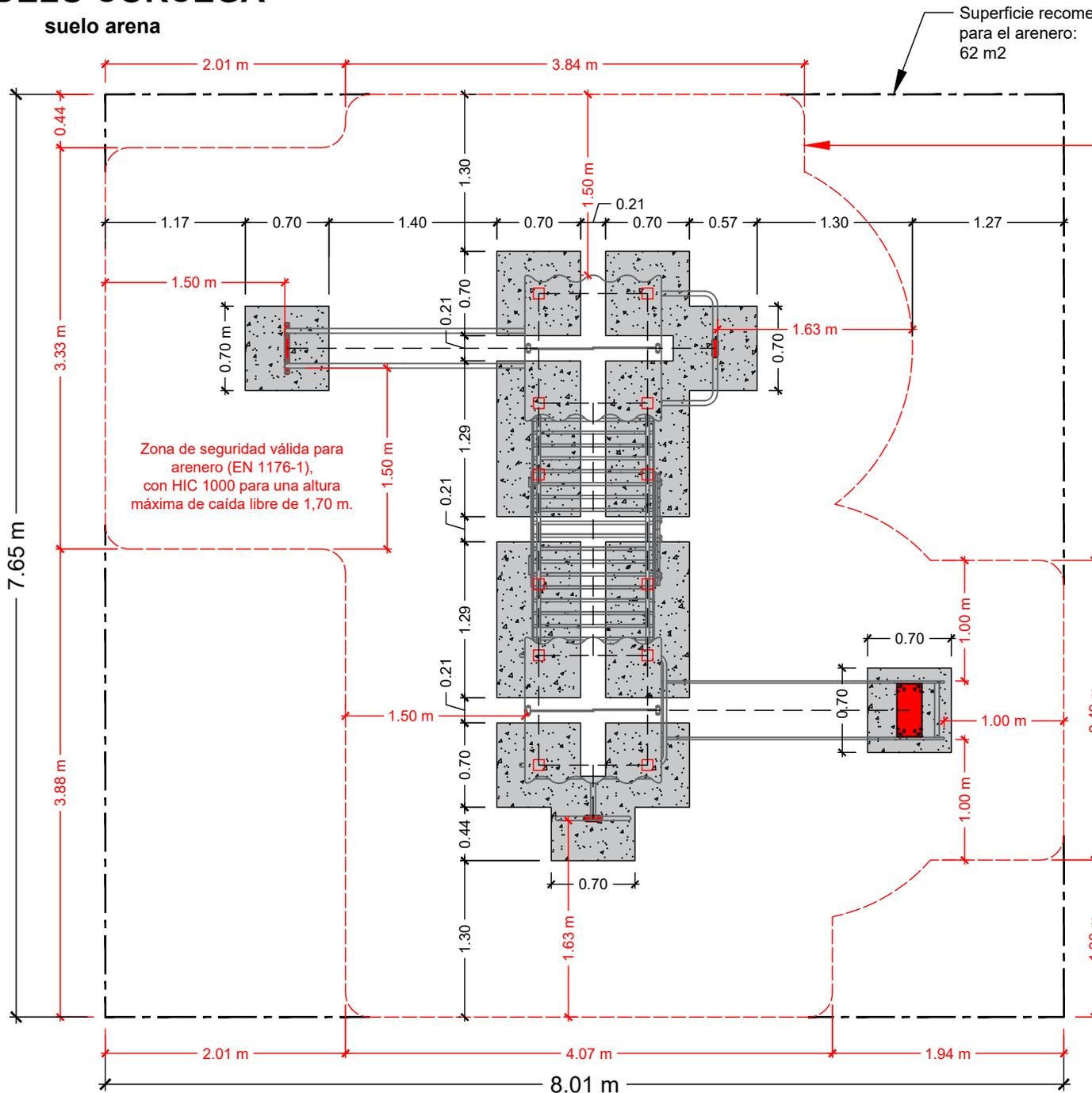
Zona de seguridad válida para arenero (EN 1176-1), con HIC 1000 para una altura máxima de caída libre de 1,70 m.
