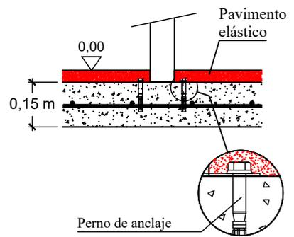
Solera de hormigón HM-20 de 15 cm de espesor en toda la zona de seguridad. Colocación de mallazo 20x20 cm ø6 mm y terminación fratasado mecánico.
