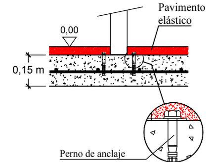
Solera de hormigón HM-20 de 15 cm de espesor en toda el área de seguridad. Colocación de mallazo 20x20 cm ø6 mm y terminación fratasado mecánico.
