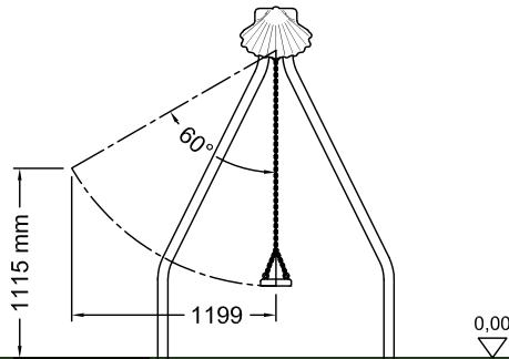
Zona de seguridad mínima, válida para pavimento elástico (EN-1176-1) con HIC 1000 para una altura máxima de caída libre de 1,13 m.
