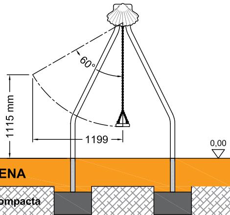
Zona de seguridad mínima, válida para material sin cohesión (EN-1176-1) con HIC 1000 para una altura máxima de caída libre de 1,13 m.
