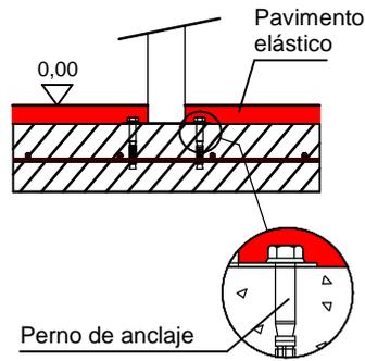
Solera de hormigón HM-20 de 15 cm de espesor en **toda el área de seguridad**. Colocación de mallazo 20x20 cm ø6 mm y terminación fratasado mecánico.
