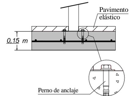
Solera de hormigón HM-20 de 15 cm de espesor en toda la zona de seguridad. Colocación de mallazo 20x20 cm  $\phi$ 6 mm y terminación fratasado mecánico.
