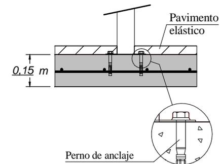
Solera de hormigón HM-20 de 15 cm de espesor en toda la zona de seguridad.
