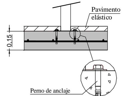
Solera de hormigón HM-20 de 15 cm de espesor en toda la zona de seguridad.
