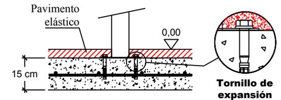
Solera de hormigón HM-20 de 15 cm de espesor. Colocación de mallazo 20x20 cm ø6 mm y terminación fratasado mecánico.
