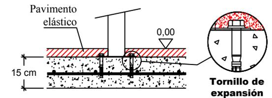
Solera de hormigón HM-20 de 15 cm de espesor. Colocación de mallazo 20x20 cm  $\phi$ 6 mm y terminación fratasado mecánico.
