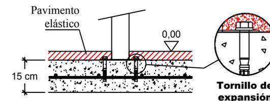
Solera de hormigón HM-20 de 15 cm de espesor. Colocación de mallazo 20x20 cm ø6 mm y terminación fratasado mecánico.
